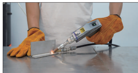
Głowica spawalnicza - "pistolet" z przewodnikiem drutu
